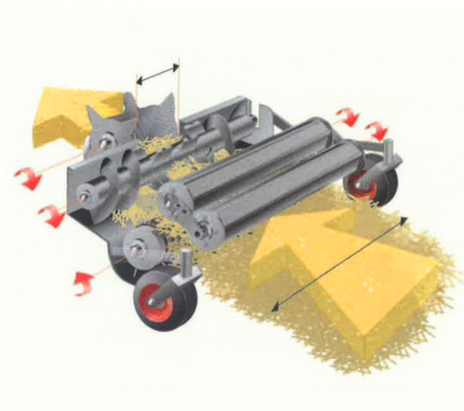
Afb. 4.3 De vijzels aan de zijkanten van de opraper brengen het gewas naar de invoerplaat. © Kamps de Wild BV
