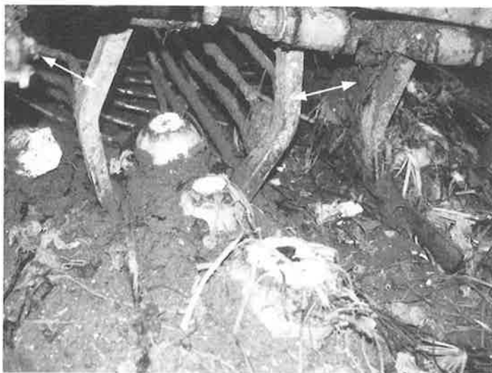
Afb. 2.10 Zelfzoekende, aangedreven rooischaren volgen de bietenrij.
