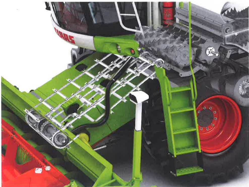
Afb. 1.4 De invoerketting transporteert het gewas naar het dorsgedeelte van het maaigedeelte. © Kamps de Wild BV
