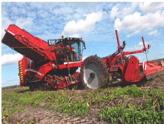
Afb. 5.6 Op de as van de loofklapper zitten klepels die het loof klappen.
