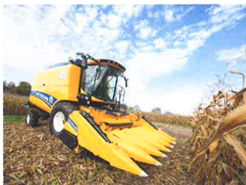
Afb. 1.40 Het maïsvoorzetstuk heeft lange punten (torpedo's) die tussen de maïsrijen doorlopen.
