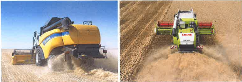
Afb. 1.10 Links wordt het stro gehakseld en rechts als zwad afgelegd.
