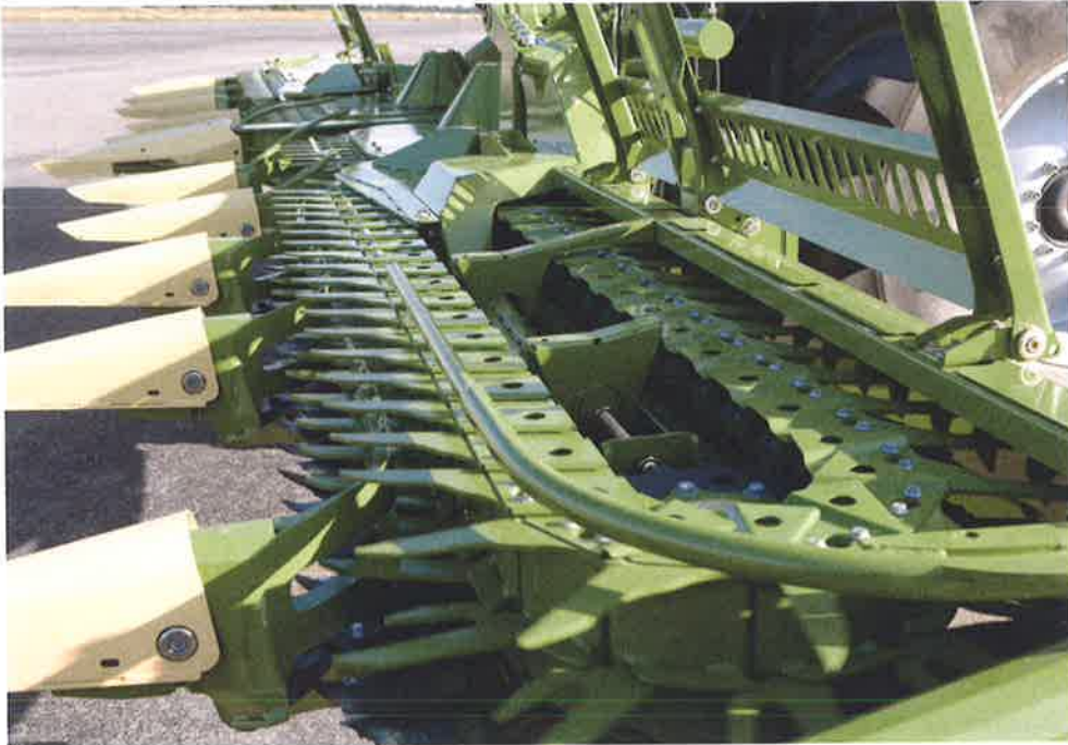
Afb. 3.5 Een voorzetstuk met rondgaande band © Krone
