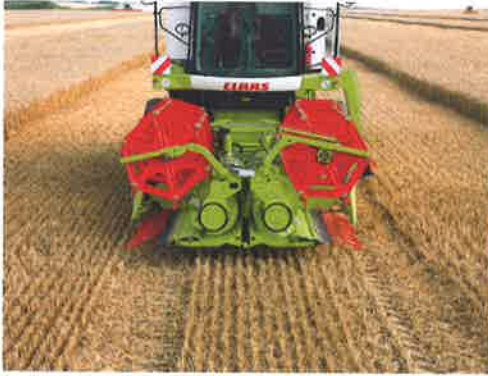
Afb. 1.19 Een aangesloten maaibord © Kamps de Wild BV
