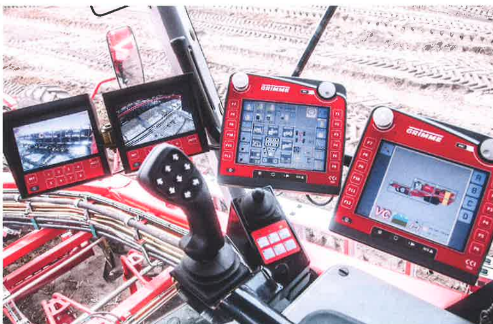
Afb. 5.22 De bedieningskast van een getrokken aardappelrooier
