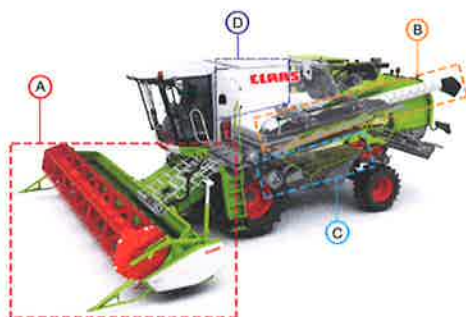
Afb. 1.2 De onderdelen van een maaidorser ingedeeld in vier groepen
