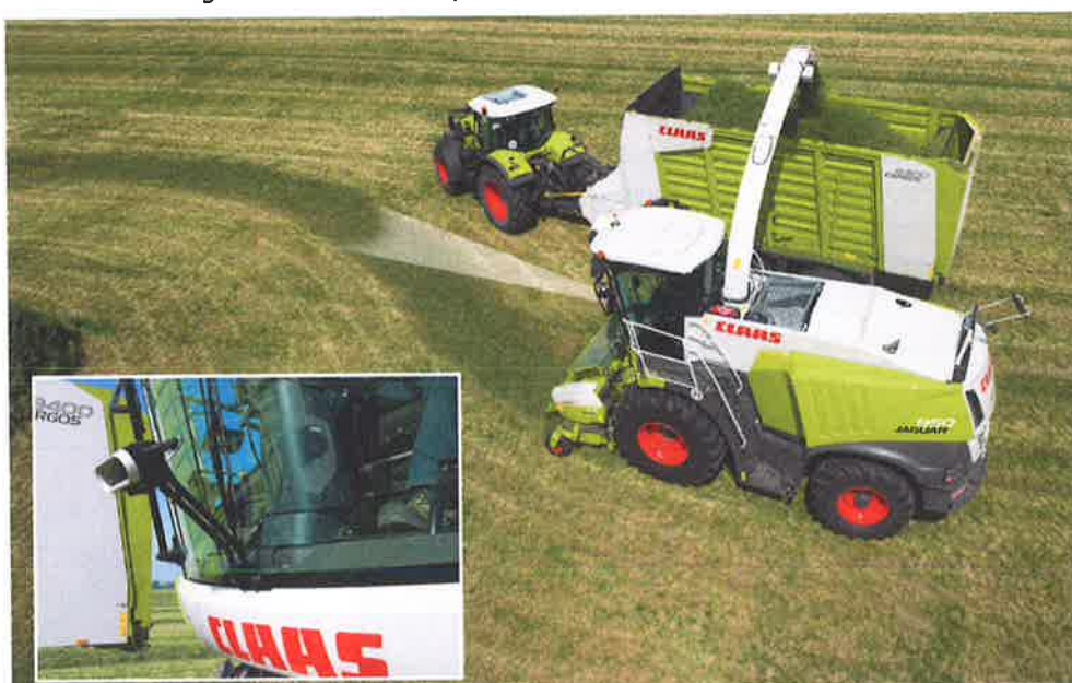
Afb. 3.8 Stuurhulp voor het grashakselen © Kamps de Wild BV
