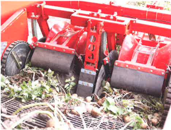
Afb. 5.9 De drukrol heeft een speciale vorm, zodat de rug goed bij elkaar gehouden wordt. © Grimme NL BV
