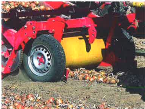
Afb. 5.35 Met de aardappelrooier kun je uien uit de grond halen en terug leggen, maar ook volledig oogsten.
