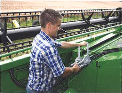
Afb. 1.20 Centrale hydraulische en elektrische aankoppeling met een eenpuntsvergrendelsysteem © John Deere Nederland BV
