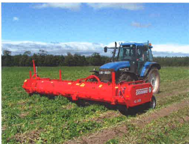
Afb. 5.5 Een getrokken rooier, waarbij de loofklapper voorop de trekker is gemonteerd
