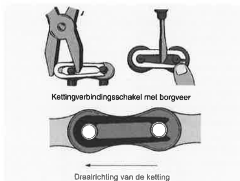
Afb. 5.32 Let erop dat je de borgveer van de sluitschakel met de opening in de goede richting plaatst.
