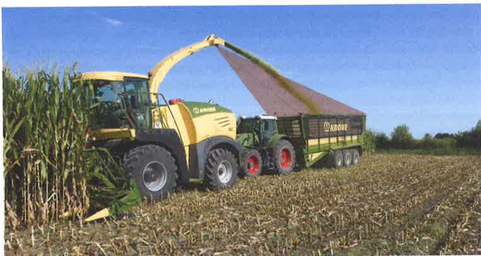
Afb. 3.17 Werking van het automatisch laden © Krone
