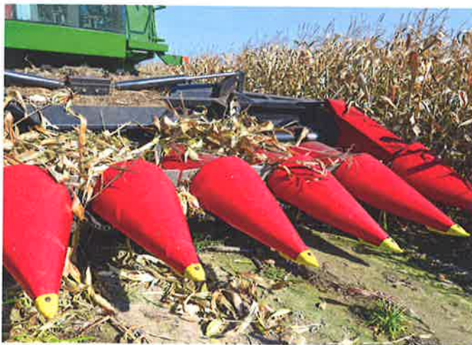
Afb. 3.7 Om maïskolvenschroot te maken gebruik je een kolvenplukker.
