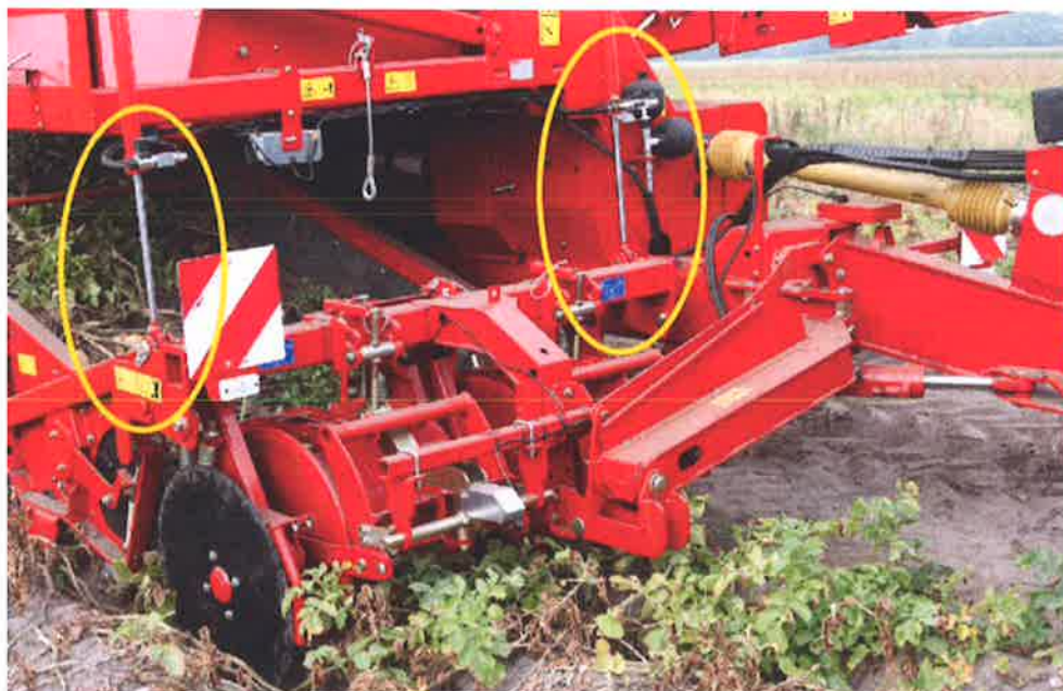
Afb. 5.23 Vlakstelling van de rooier via de rooiunit
