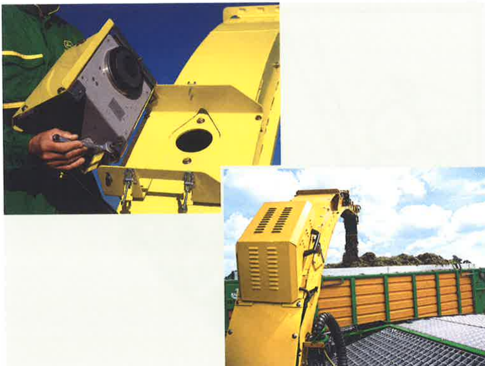
Afb. 3.16 Een drogestofmeter om de kwaliteit van het gewas te meten © John Deere Nederland BV
