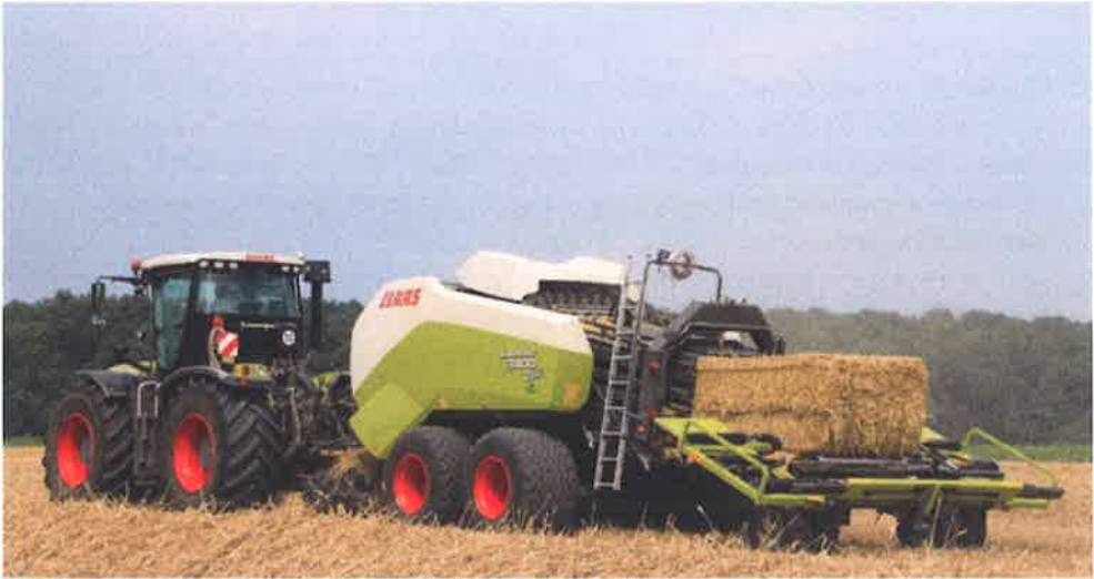
Afb. 4.30 Bij het persen van stro wordt soms een verzamelwagen gebruikt. © Kamps de Wild BV
