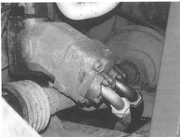
Afb. 2.25 Via een hydromotor worden de wielen aangedreven.
