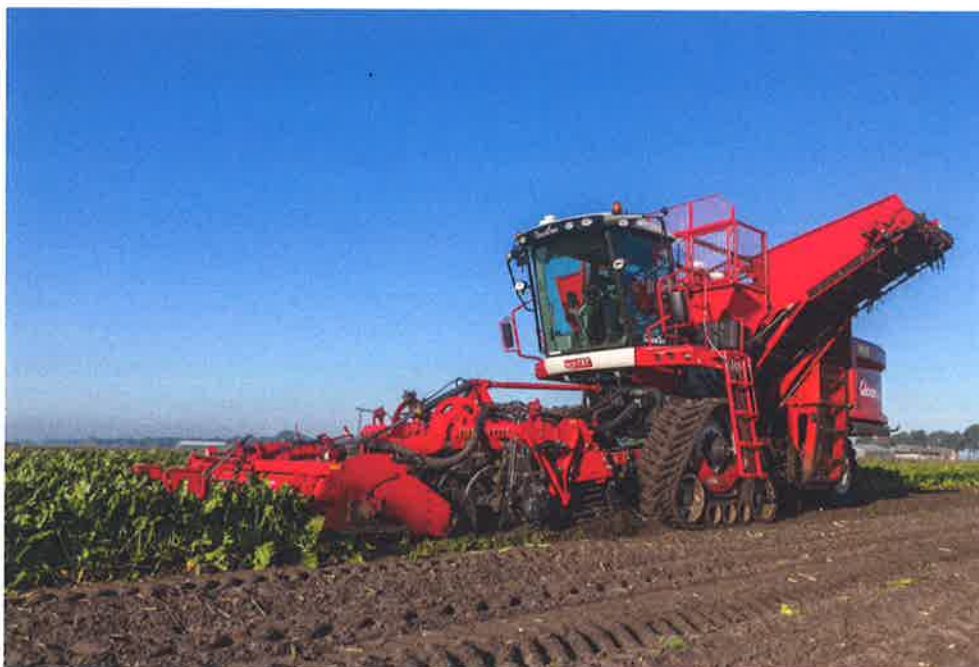
Afb. 2.1 De bietenrooier Agrifac Quatro © Agrifac Machinery B.V.
