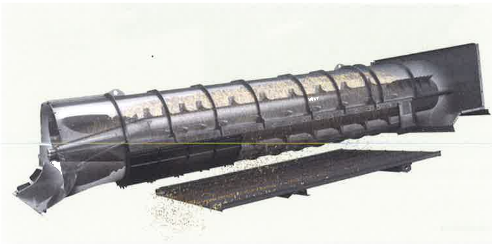
Afb. 1.9 Een axiaaldorser bestaat uit één of twee vijzels die een roterende beweging maken. © Kamps de Wild BV
