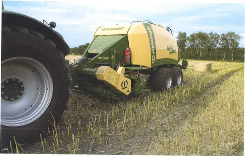
Afb. 4.5 Voorbouwhakselaar voor het hakselen van stro © Krone
