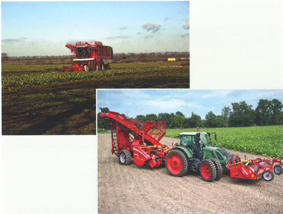
Afb. 2.6 Het koppen en rooien vindt voor de wielen plaats. © Grimme Nederland BV
