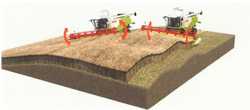
Afb. 1.45 Autocontourvolgning in het veld © Kamps de Wild BV
