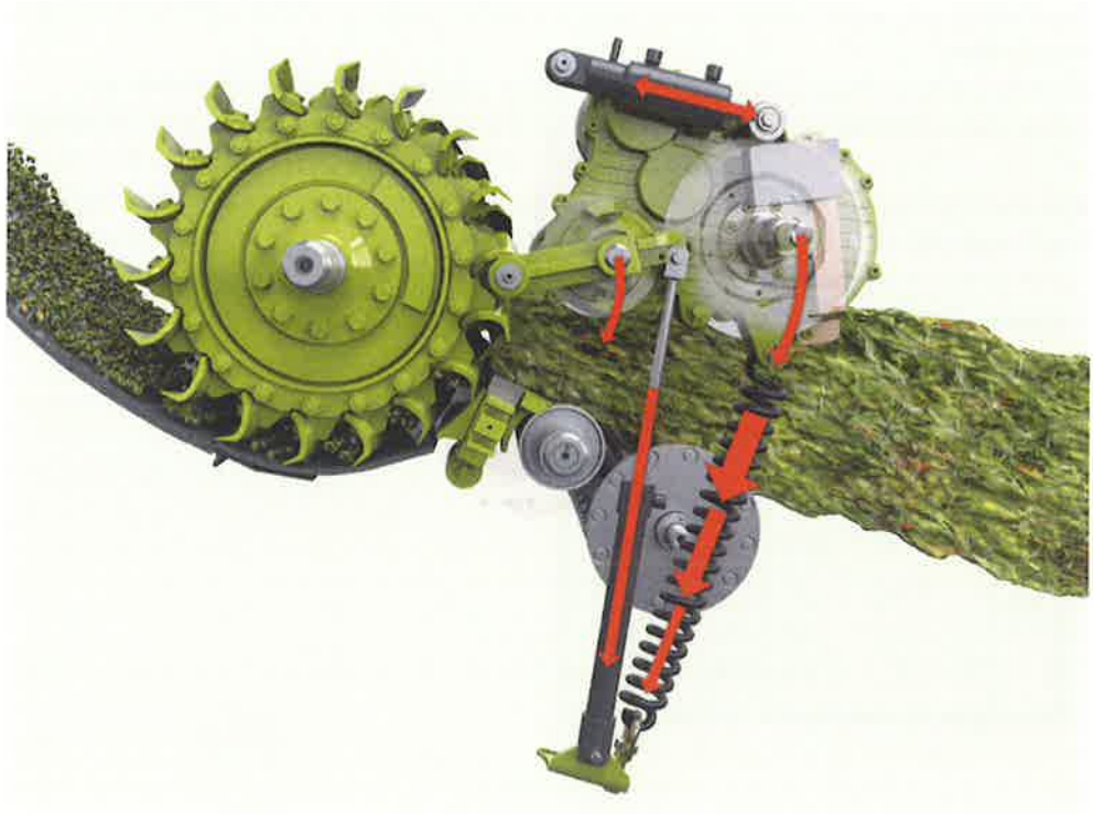
Afb. 3.9 Invoerrollen drukken de gewasstroom samen voor een compacte gewasstroom.
