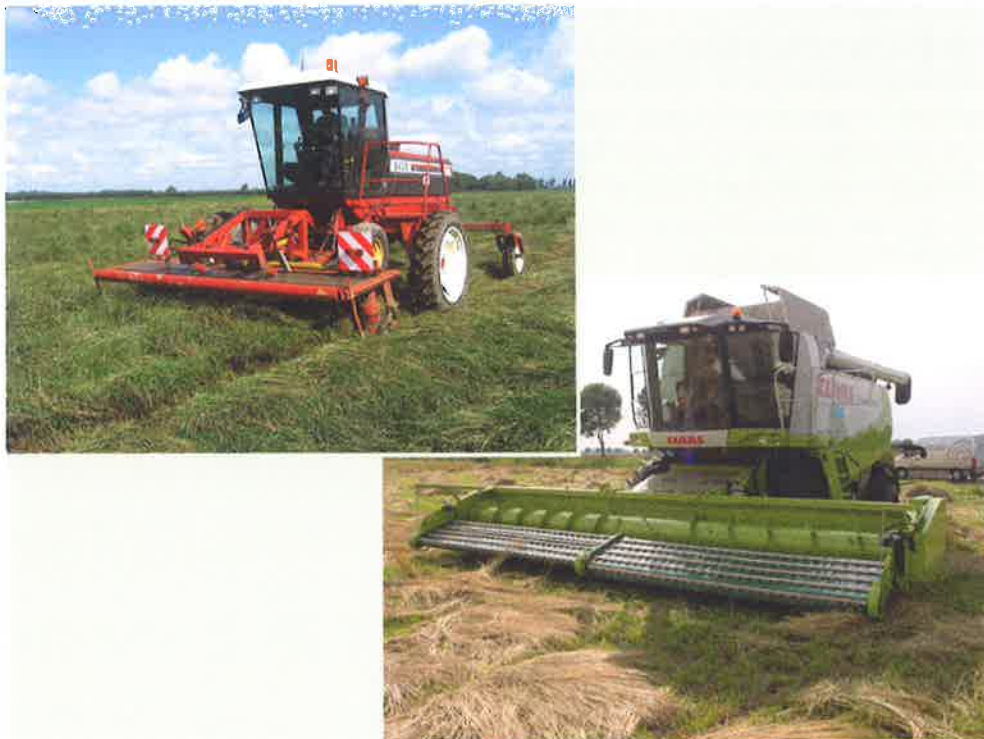
Afb. 1.38 Een zwadmaaiër (linksboven) en een combine met doekopaper (rechtsonder)
