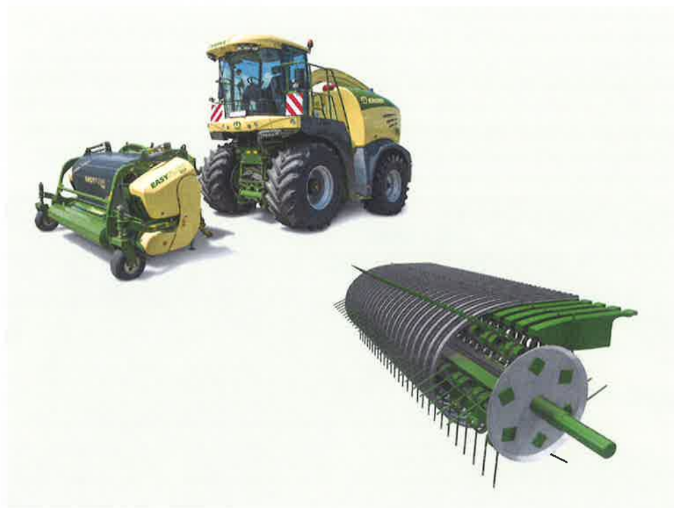
Afb. 3.3 Voor gras en luzerne gebruik je een pick-up als voorzetstuk. © Krone
