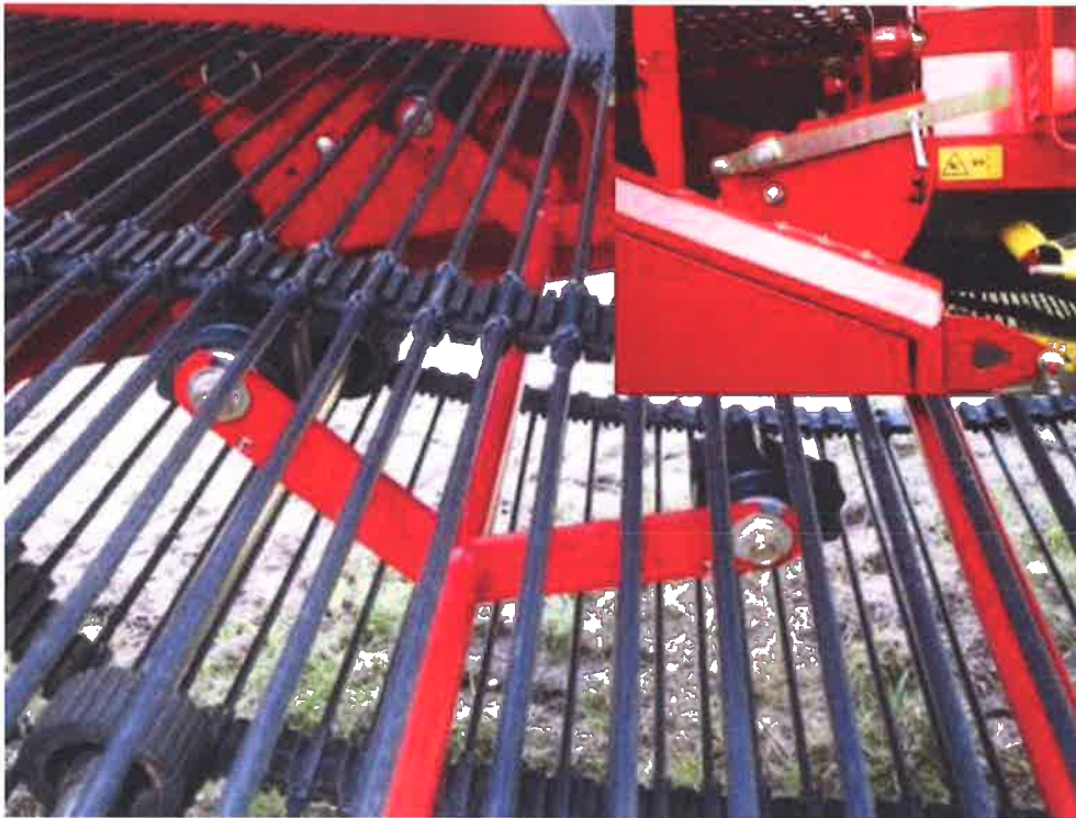
Afb. 5.15 Een aangedreven klopper onder de zeefketting schudt de grond tussen de aardappels uit. © Grimme NL BV
