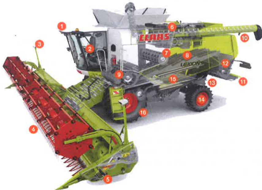
Afb. 1.13 De onderdelen van een maaidorser
