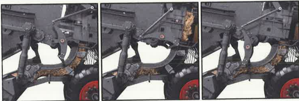
Afb. 4.10 Per slag van de perswagen worden drie laagjes in het perskanaal gebracht. Per drie slagen van de voorpersinrichting maakt de perswagen een slag. © Kamps de Wild BV
