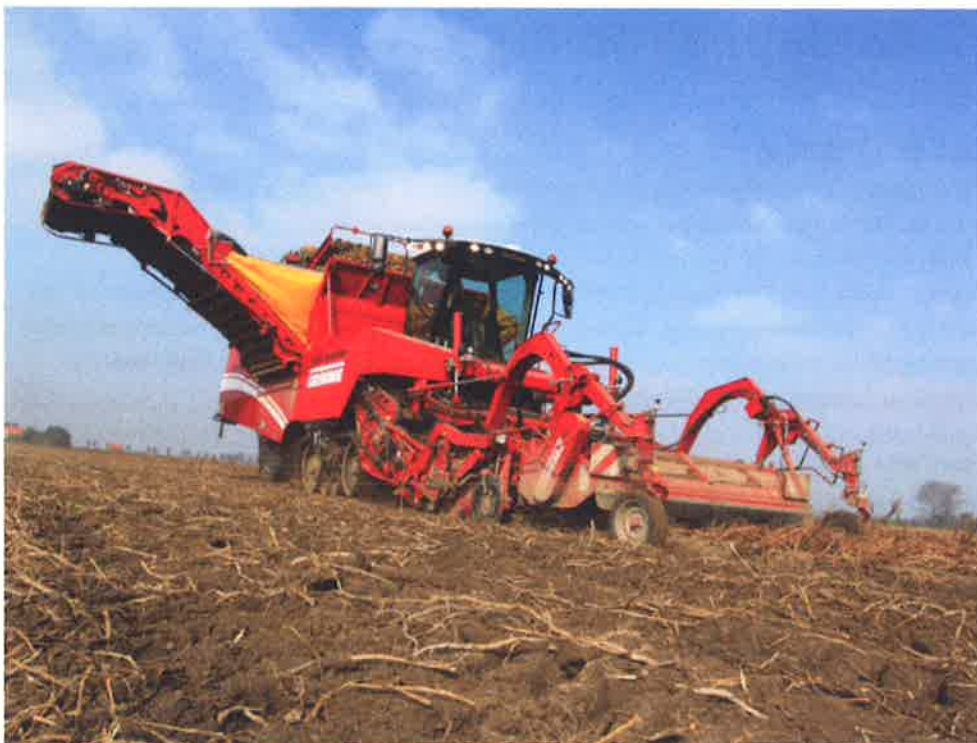
Afb. 5.2 Vierrijige 15-tons bunkerrooier op rupsen © Grimme NL BV
