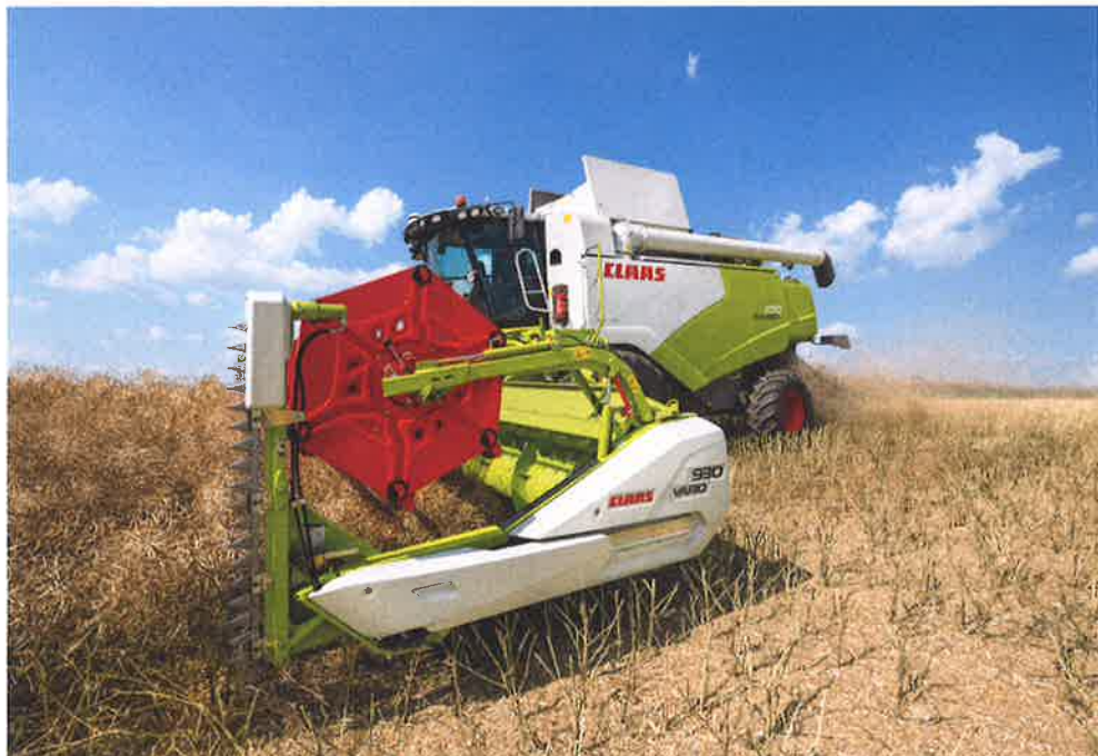
Afb. 1.5 Een maaibord met een verticaal mes voorkomt zaadverliezen. © Kamps de Wild BV
