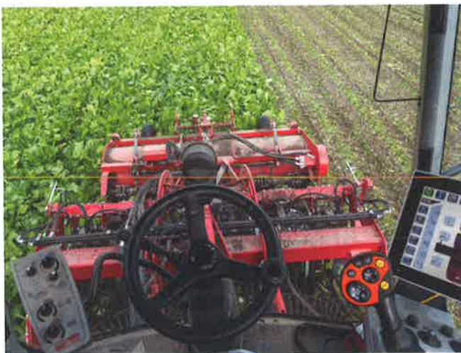
Afb. 2.20 De stuurcabine. Met een bedieningsterminal op de stuurkolom, een bedieningsterminal in de armleuning en een bedieningsscherm veldmodus. © Agrifac Machinery B.V.
