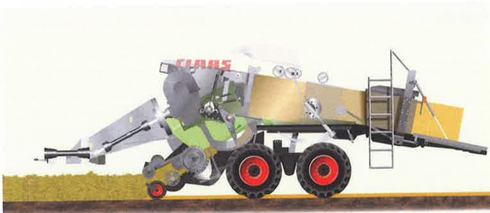
Afb. 4.11 De roterende voorpersinrichting brengt in hetzelfde ritme als de perswagen stro in kleine hoeveelheden in het perskanaal.
