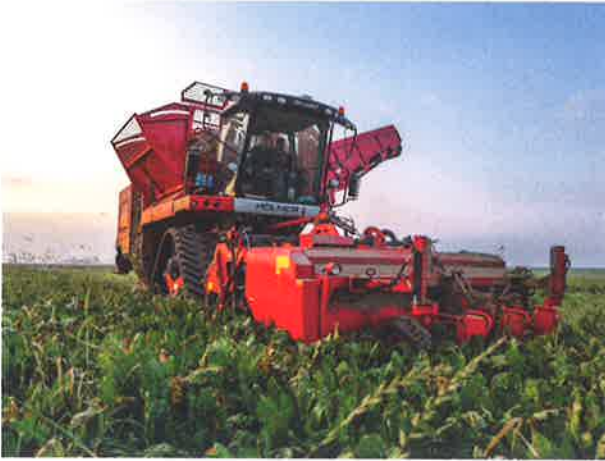
Afb. 2.3 Een bietenrooier met eenfasensysteem © Agrifac Machinery B.V.
