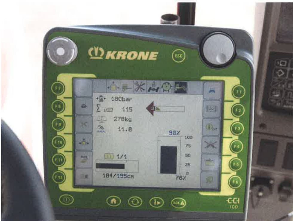
Afb. 4.24 Een voorbeeld van een boordcomputer
