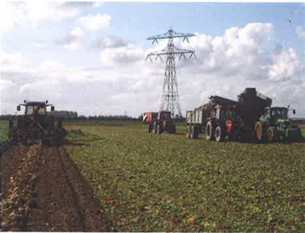
Afb. 2.4 Een bietenrooier met tweefasensysteem
